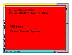
Vérifier l'absence de corps étranger dans le ventilateur, puis remettre le contrôleur sous tension. Si l'écran d'erreur s'affiche de nouveau, contacter le représentant local ou le bureau des ventes de YOKOGAWA.
