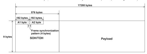
A1 byte: "F6F6F6---F6"h (192 bytes) A2 byte: "282828---28"h (192 bytes)
